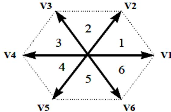
Fig 7 non-zero voltage vectors on page dq
